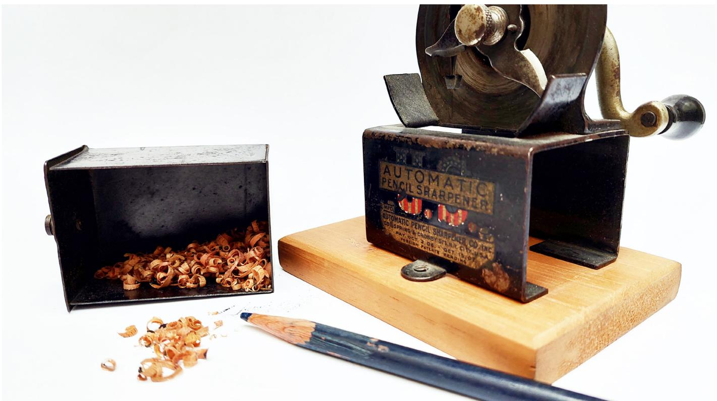
Sacapuntas fabricado por Automatic Pencil Sharpener Co. Estados Unidos, 1906 - 1909. Posee tres cuchillas y un cajón recolector de viruta.
